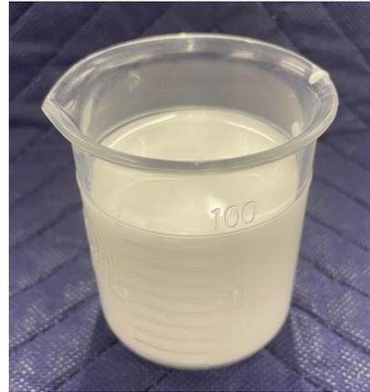
写真-1 代表的な酢酸ビニール系の侵食防止剤（液体タイプ）
