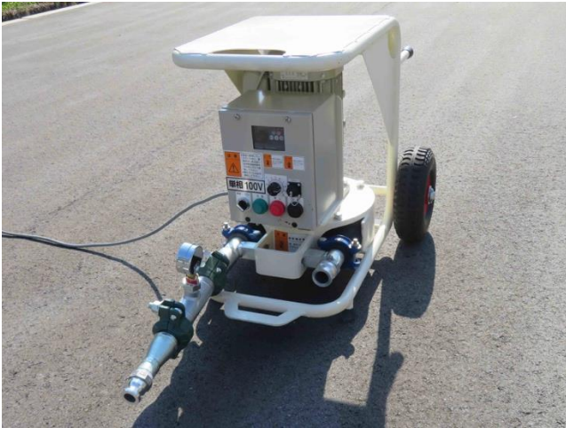
写真2 和歌山地域植物研究会が試作した後撒き機
