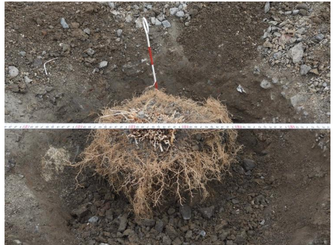
写真1 砕石で締め固められた駐車場で育成したチカラシバの根圏（播種半年後）
