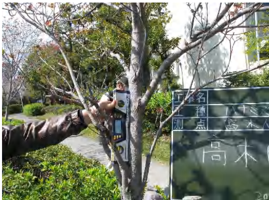
傾斜角の測定状況
