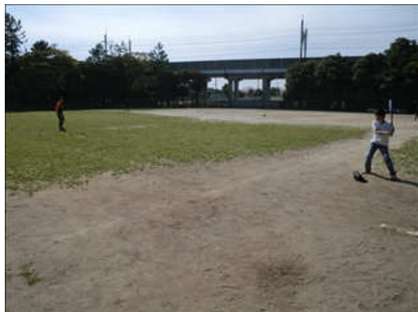
グラウンドに噴砂が発生している。
