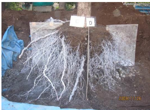
写真4 右は再生砕石のみ、左は再生砕石に助材を付着させた。（クスノキ4年4ヵ月後）
