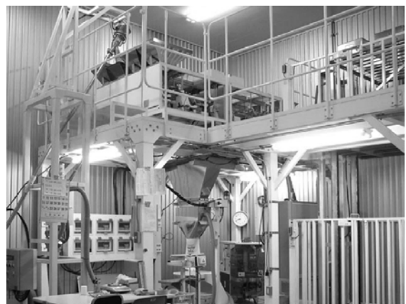
写真-2 RSセンターの種子計量袋詰め装置
